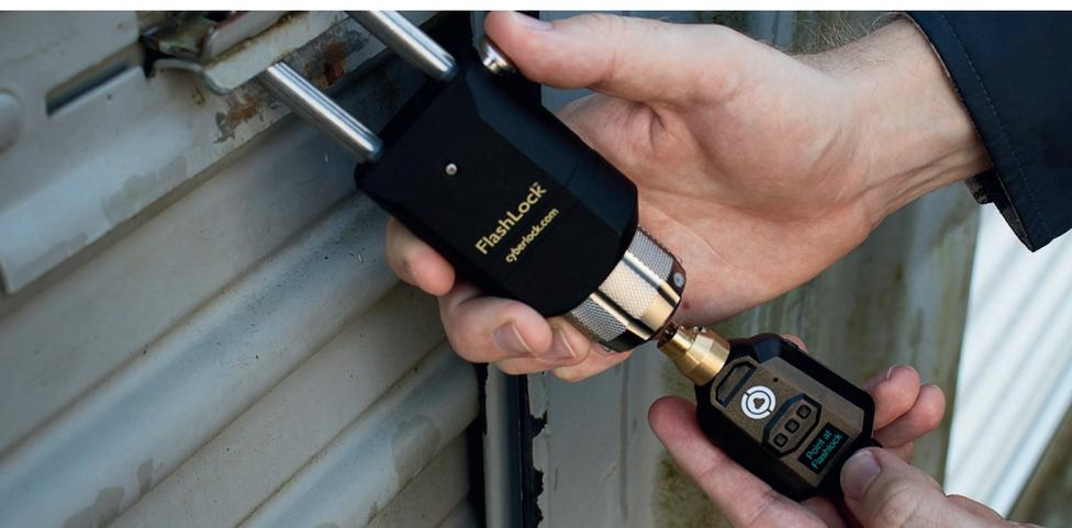
*L'utilisateur tient la CyberKey Air 2 à proximité d'un cadenas FlashLock pour y accéder grâce à la technologie infrarouge.*
